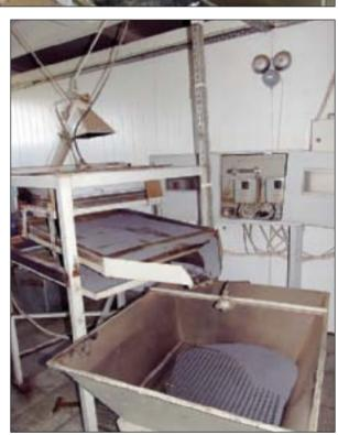
Макодробилка. Это все полностью самоделка, где Веспер управляет несколькими двигателями мощностью по 5 кВт (плавный разгон - плавная остановка)
